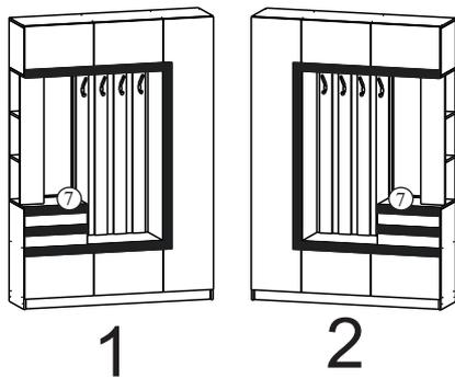
В детали №7 досверлить 2 отверстия сверлом D8 согласно схеме.
